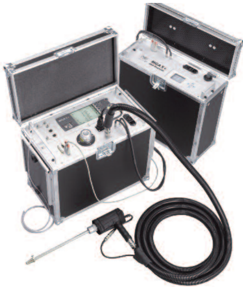
Фото 1. Мобильный полустационарный газоанализатор MGA5+
